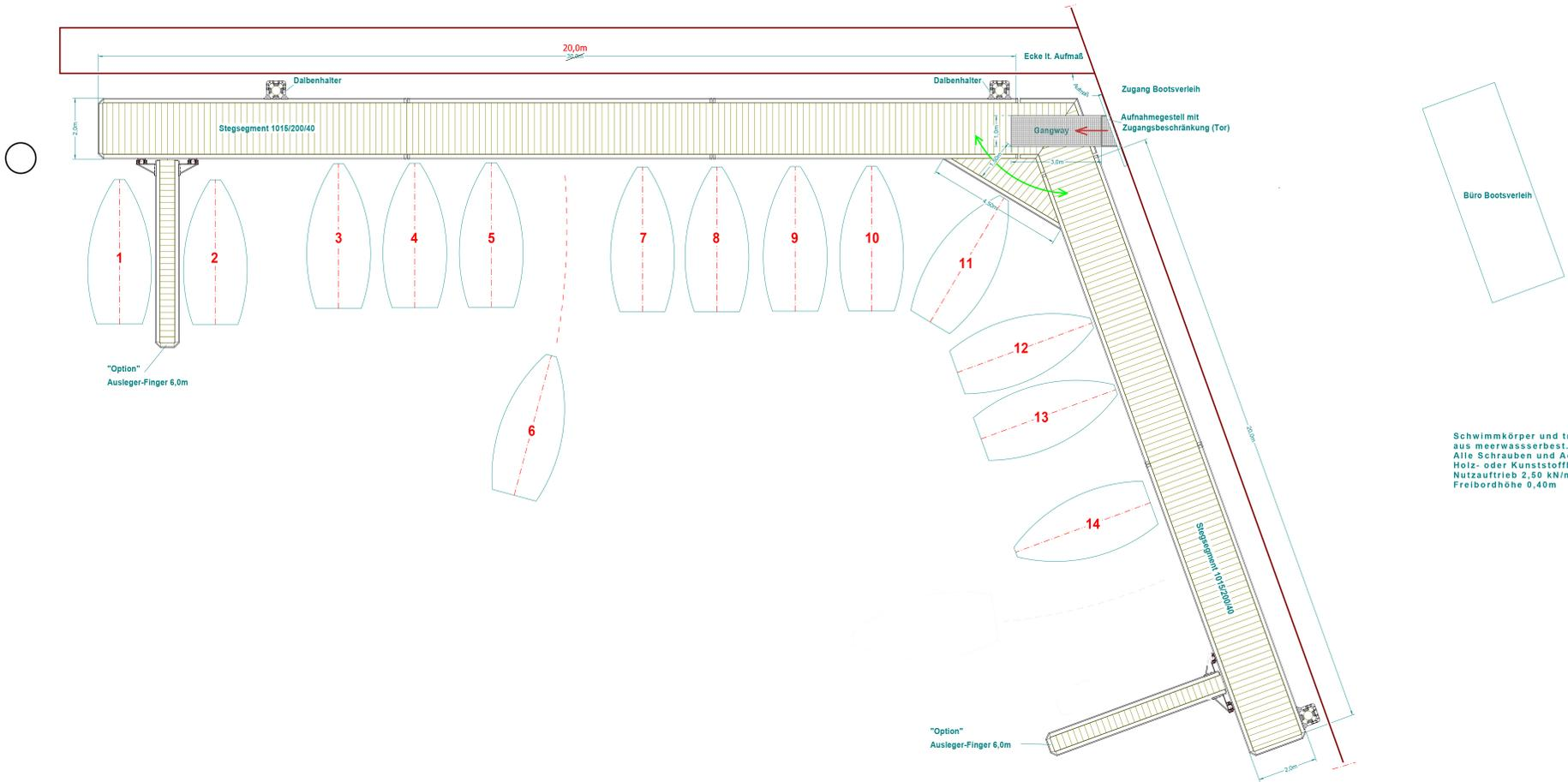
Schwimmkörper und tragende Konstruktion aus meerwasserbest. Aluminium AlMg.3
