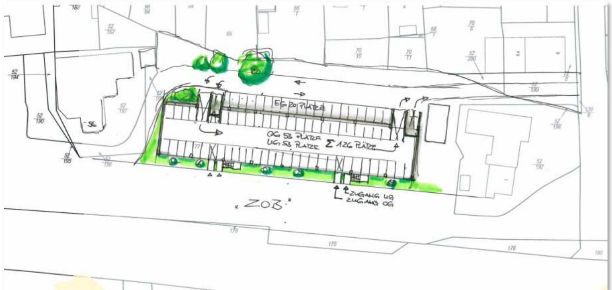
Abb. 2: Variante I – Split-Level-Parkhaus mit 2 Ebenen
