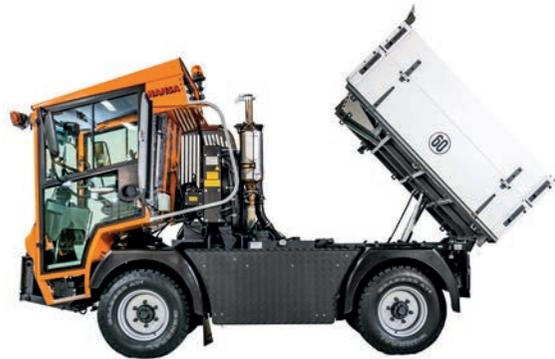
Fahrerhaus hydraulisch kippbar // *Hydraulically tiltable driver's cab*
