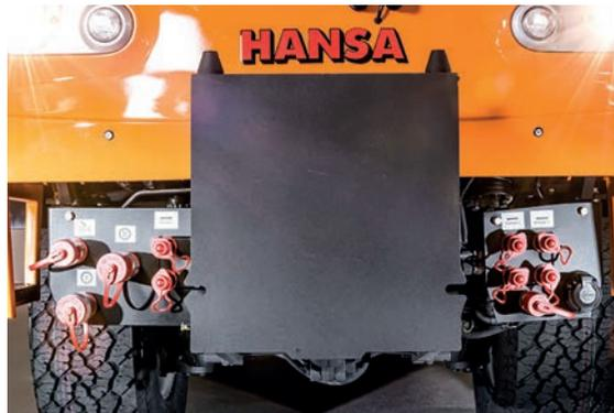
Massive Frontanbauplatte mit Parallelführung
